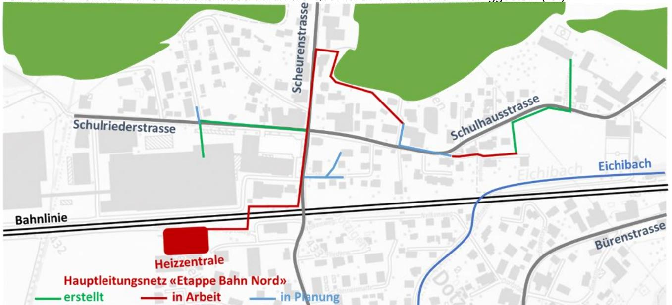
Abbildung: Skizze zur Leitungsführung und deren Stand der Arbeiten August 2022
